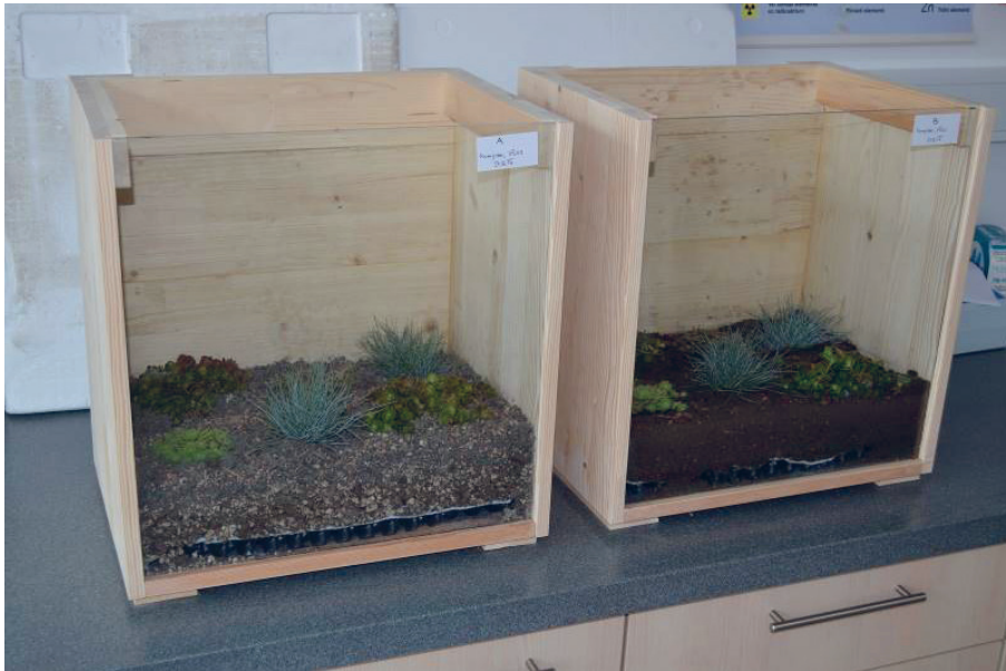
Slika 1: Prikaz pilotnih modelov A in B z različnima substratoma
